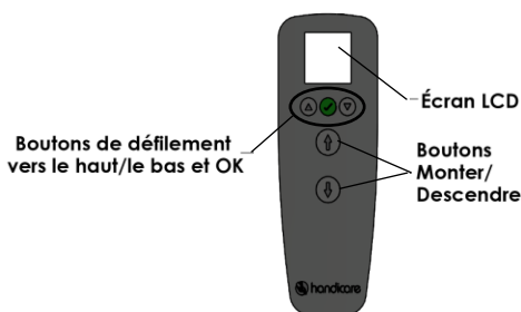
Illustration 4 : Disposition des boutons de la commande manuelle de l'AP-450
