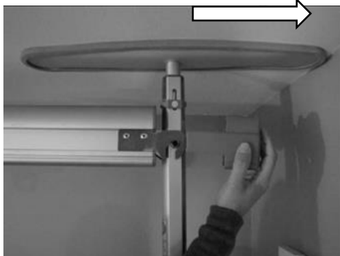
Figure 32 : Enlever les capuchons des extrémités sur les deux colonnes
