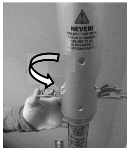
Figure 15 : Ouvrir complètement le niveau de la colonne
