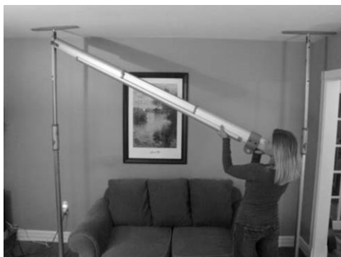
Figure 34 : Serrer et décrocher le rail
