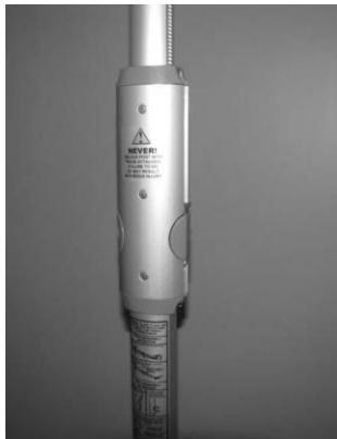
Figure 21 : Bouton de verrouillage de sécurité et niveau enclenchés
