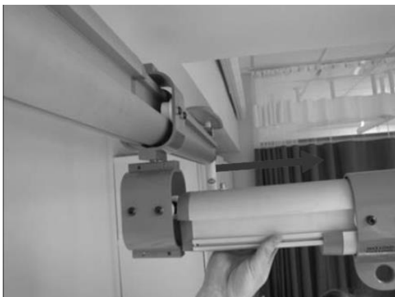
Figure 31 : Enlever la glissière transversale du chariot
