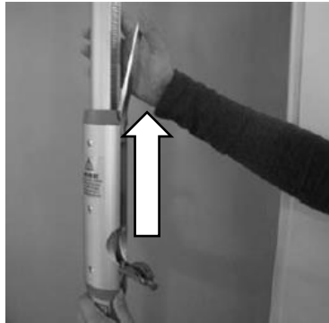
Figure 39 : Pousser le levier pour l'engager l'aimant
